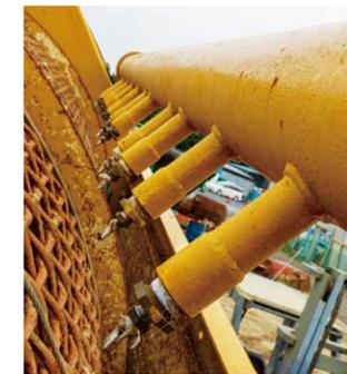
ドラム式スクリーンの外に設置。空気圧で網に付いた付着物を除去して稼働中のメンテナンス回数激減を実現。回転を止めることなく稼働できるうえに、ブラシは設置していないのでメンテナンスの時間を1～2時間程度削減。
