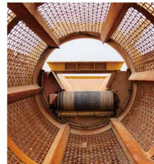
ドラム径1.8 mの大きなtrommelで投入物をほぐしながら、遠心力によるはく離効果で高精度分別。すでに振り分けられたミドルから、さらに表面に付着したアンダーを分別するなど振動式スクリーンとセットで使うのも効果的。
